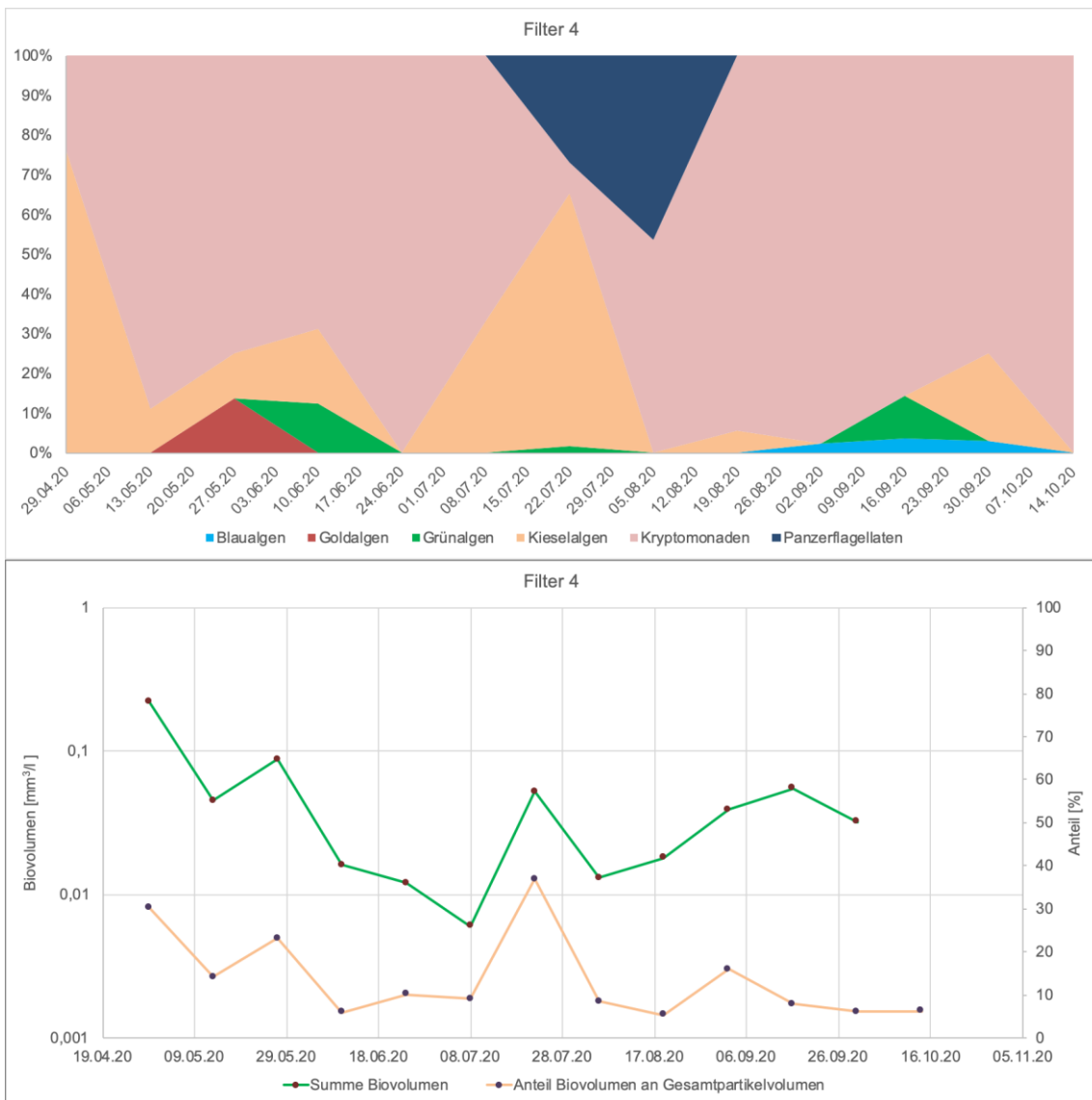
Abbildung 22: Ablauf Filter 4, prozentualer Anteil der Algenklassen am Gesamtbiovolumen oben, sowie Summe Biovolumen in \text{mm}^3/\text{l} und prozentualer Anteil am Gesamtpartikelvolumen (Differenz besteht aus organischen Partikeln, anorganische Partikel nicht mitgezählt) unten
